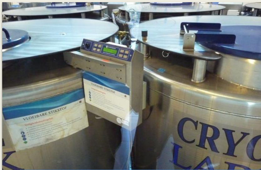
Folyamatos számítógépes hőmérséklet ellenőrzés van. Kb.6 millió mintát tudnak tárolni.
