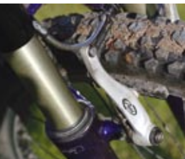
Bár egyre több bringán van tárcsafék, a V-fékek egyszerűségük és könnyűségük révén még sokáig nem fognak eltűnni.
