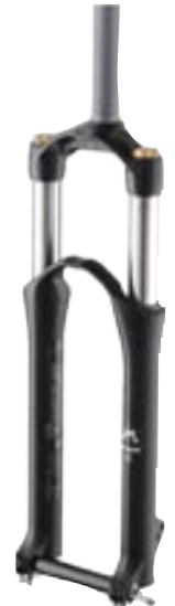
A durvább igénybevételre szánt telók egy része saját átütéssel kerül forgalomba, ami merevebbé teszi a bringa elejét, de speciális agyat igényel.
