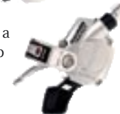
A minőségi bringákon a Shimano RapidFire Plus váltókarja fordul elő a leggyakrabban, amelyhez hasonló a SRAM is gyárt.
