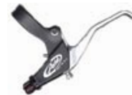
A bowdenes fékkarok bármilyen V-fékekkel és bowdenes tárcsafékekkel használhatók.
