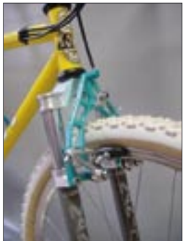
Ilyen volt az első Manitou teleszkóp 1990 tájékán. Akkoriban ugyanazt a villát használták a CC-sek és a DH-sok is.
