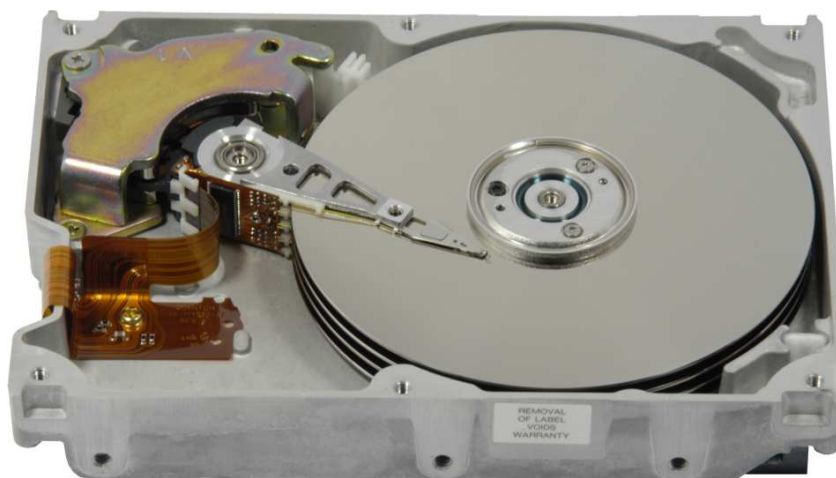
6.2. ábra. Vékony-film réteget használó winchester
