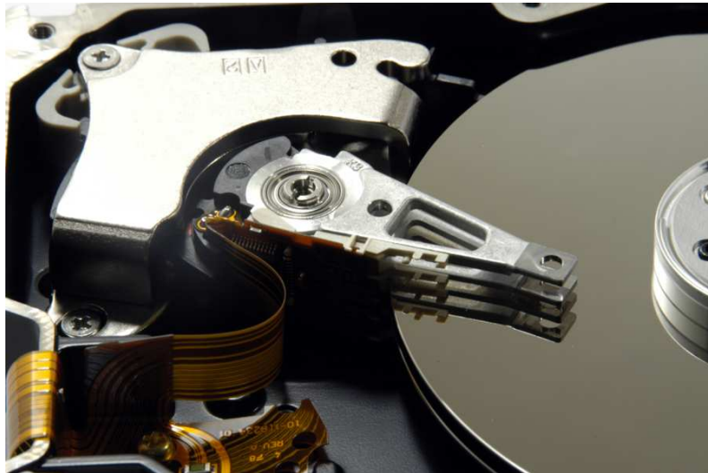
6.3. ábra. A mechanika további lemezek és fejek beépítését teszi lehetővé.
