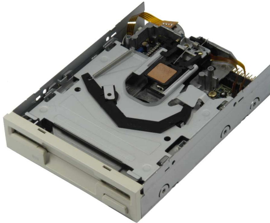
5.5. ábra. 1,44 MB-os floppy meghajtó (tető nélkül)
