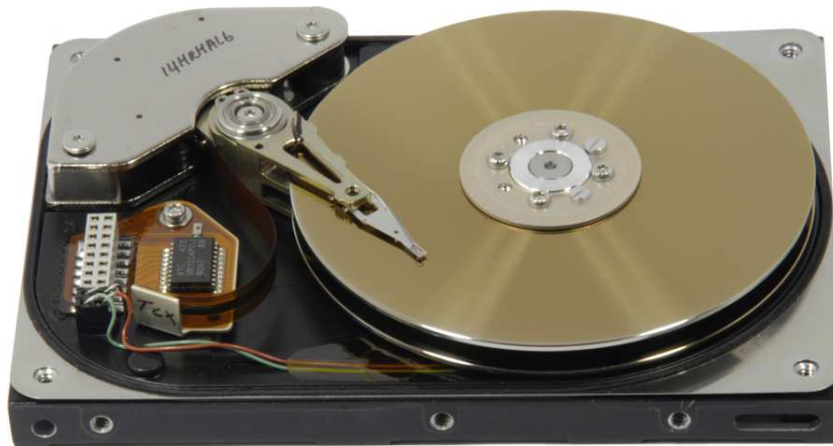
6.1. ábra. Vas-oxidréteg bevonatot használó winchester
