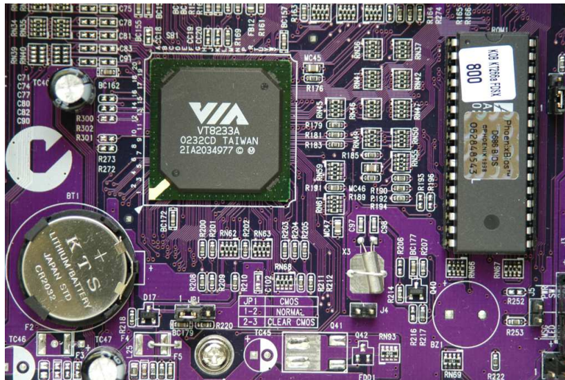
2.12. ábra. Az alaplapi BIOS és energiaellátása
