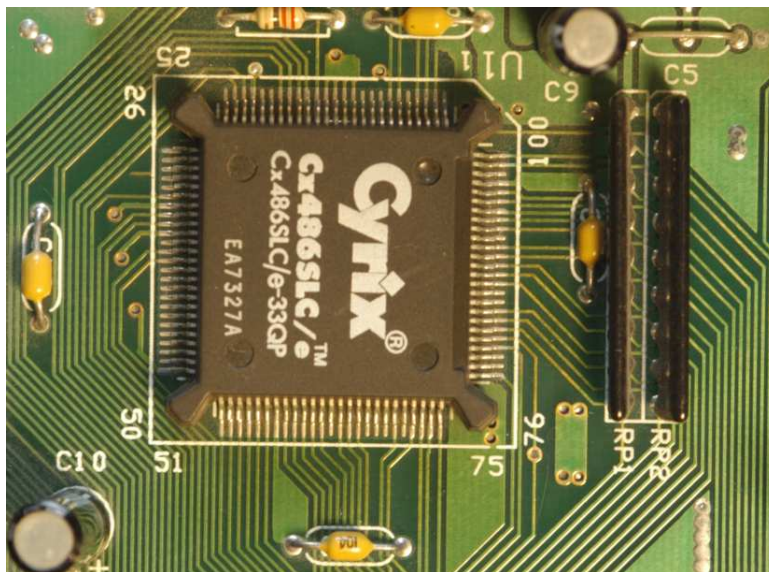
2.10. ábra. 486 SLC processzor az alaplaphoz integrálva
