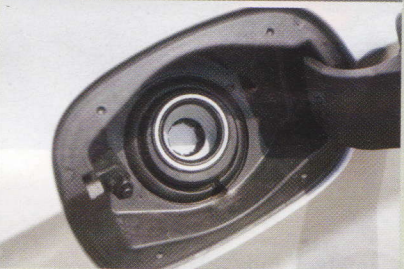
Ötletes a szűkítőcső. Így még véletlenül sem tankolható benzin a dízel változatba
