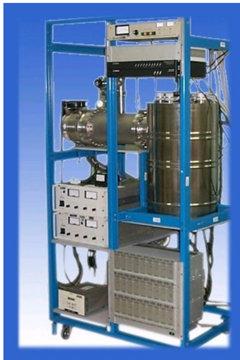
6. ábra. A magyar fejlesztésű UMC, vagyis Univerzális Sokzónás Kristályosító berendezés, mellyel magas szintű anyagtudományi kísérleteket lehet végezni, akár az űrben is.
