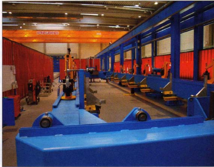
Nagyméretű hegesztett szerkezet készülőke többcélú, állítható elemekkel
