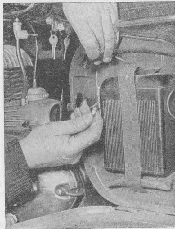
Obr. 97. Odpojení akumulátoru od elektrické soustavy
