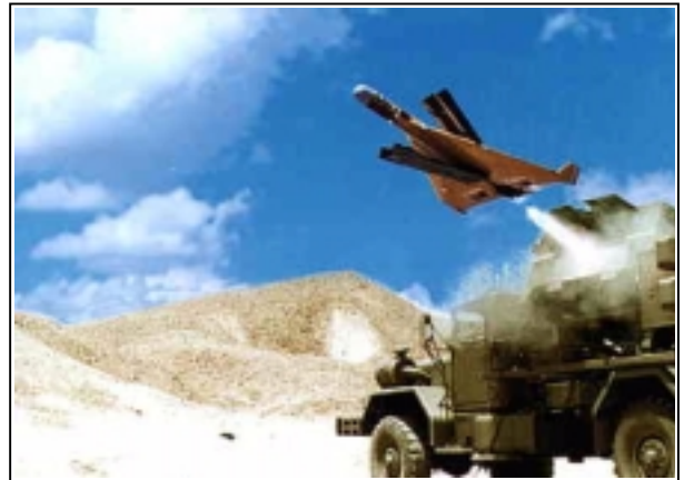
35. ábra Az izraeli HARMY rádiólokátor elleni, önrávezető PNR
