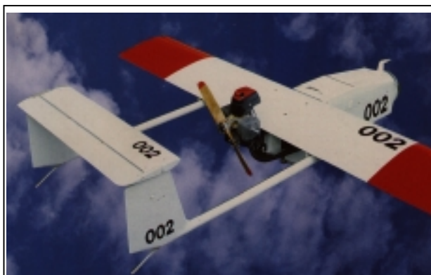
17. ábra A hagyományos kétütemű, kéthengeres motorú SZOJKA
