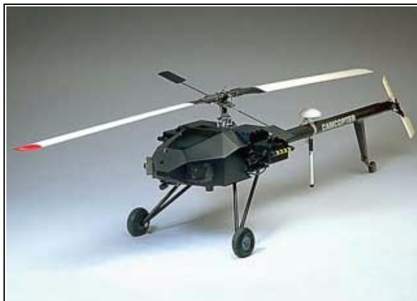
41. ábra A CAMCOPTER kisméretű, tv-kamerás, aknamező felderítő PNR
