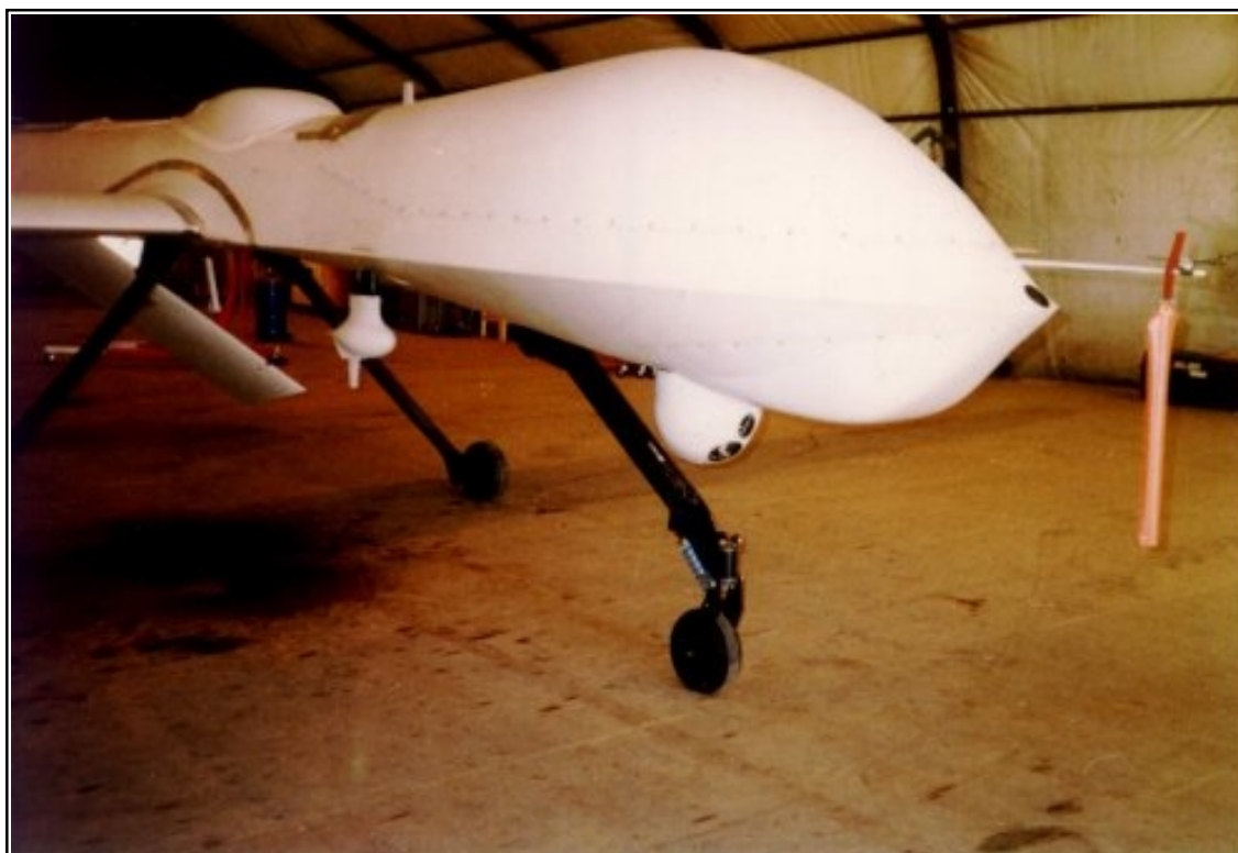
67. ábra Az amerikai PREDATOR a taszári bázison bevetés előtt, az orr-részben a navigátor számára az előrenéző kamera, míg az alatta levő gömbben a többi felderítő szenzor látható
