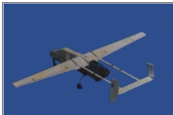
39. ábra A vegyi- és sugárfelderítő hasznos teherrel is rendelkező MALAT
