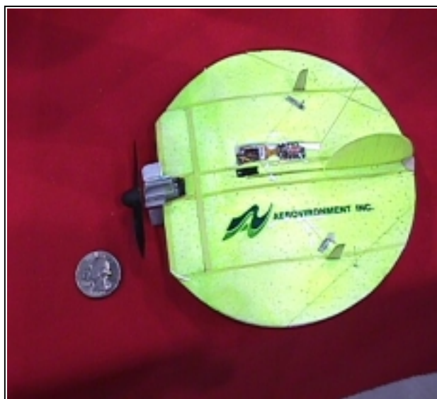
72. ábra Az Aerovironment Inc. működőképes mikro PNR-je
