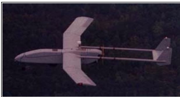
37. ábra A rádió iránymérő hasznos teherrel is rendelkező SHADOW 600
