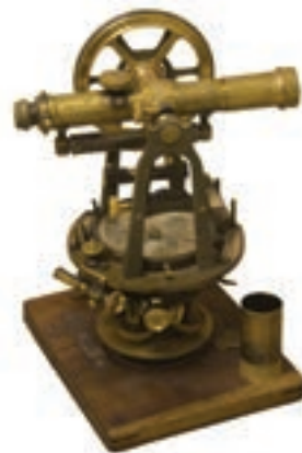
1.9. ábra Teodolit régen (Starke-Kammerer gyártmányú teodolit a XX. század elejéről)
