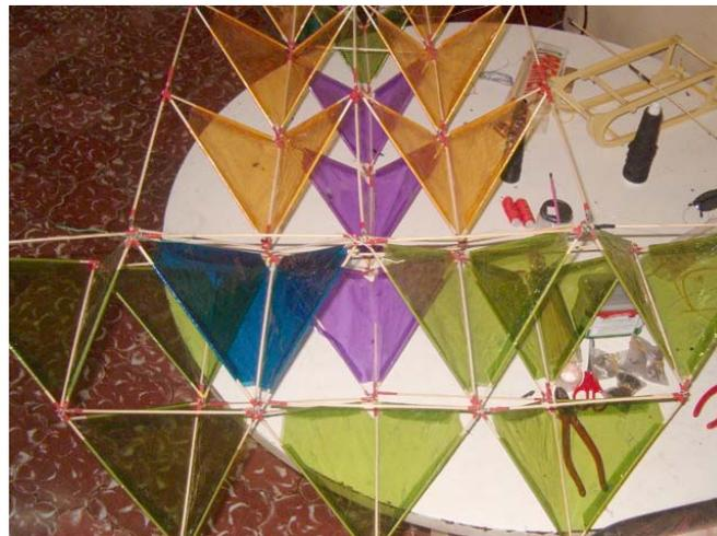
La forma de colapsar el cuerpo, es utilizando conectores en forma perpendicular al largo, pero en este caso, como se conecta en los extremos, sólo ocuparemos tres conectores, dos arriba, y uno al centro. Esto será suficiente, pues el soporte adicional lo dan las cometas de los extremos. La foto de la derecha, ilustra la posición utilizada para los palitos que se desmontan, y lograr que colapse.
