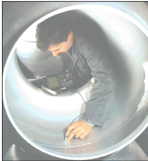
1.23. ábra Cső hegesztési varratának vizsgálata a belső felületen
