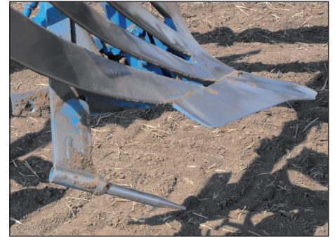
1. ábra – Lazítótűskével szerelt réses kormánylemez eké
