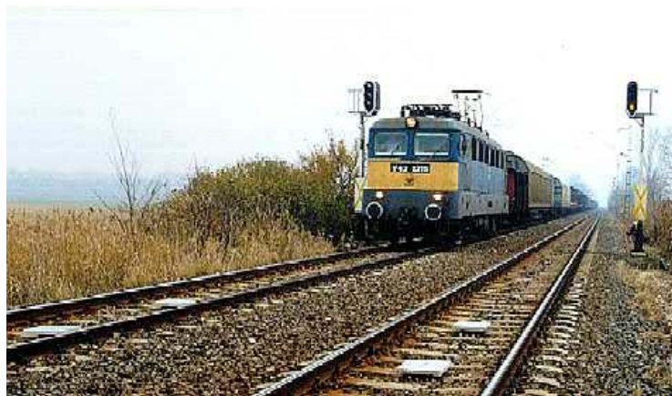
61. ábra – V43 1316 elhalad egy tehervonattal a telepített jelfeladók felett
