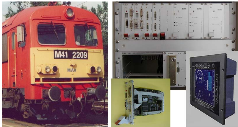
13. ábra – Alcatel 6413 ETCS 1-es szintű fedélzeti rendszer a MÁV M41 sorozatú mozdonyán
