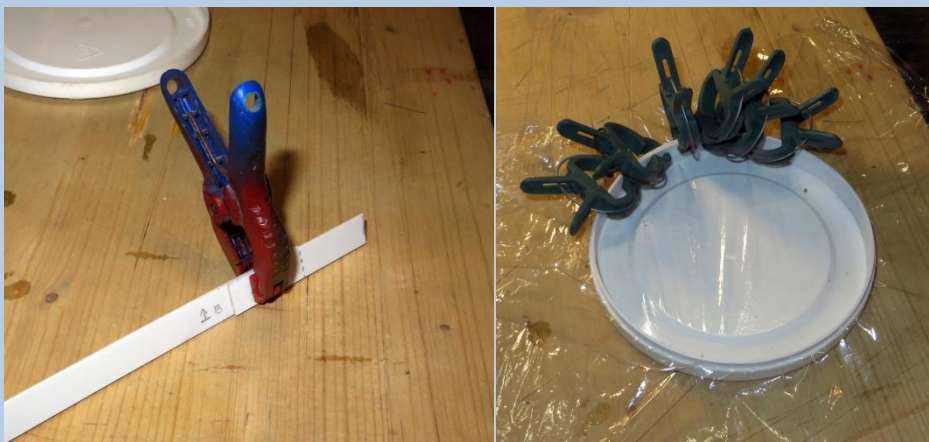
A peremszalag pontos méretre ragasztása.
