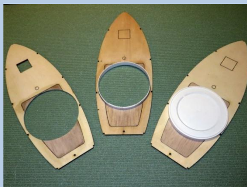
A peremszalag illesztése a fedélzetlemezbe
