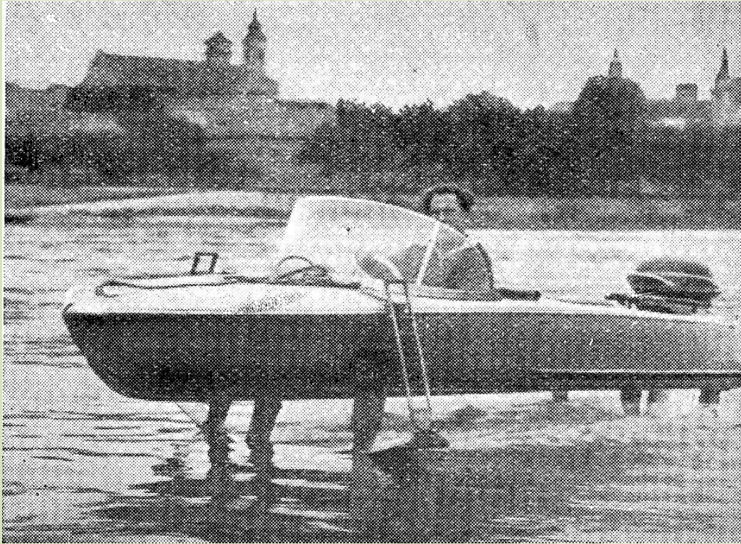
41. ábra. A váci szárnyas motorcsónak
