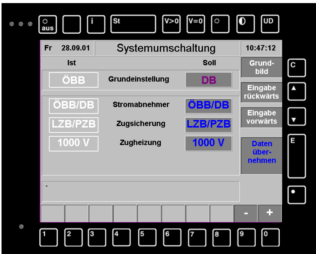
Abb. 18-5: Rendszerátkapcsolás ÖBB-ről DB-üzemmódra
