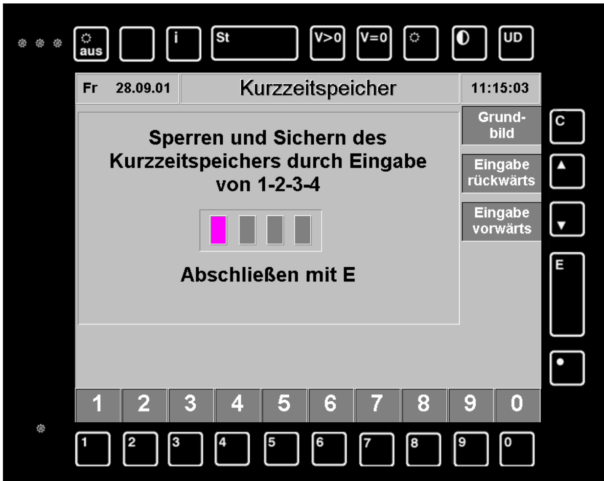
Abb. 18-28: Maradékút-tároló blokkolása és a blokkolás feloldása
