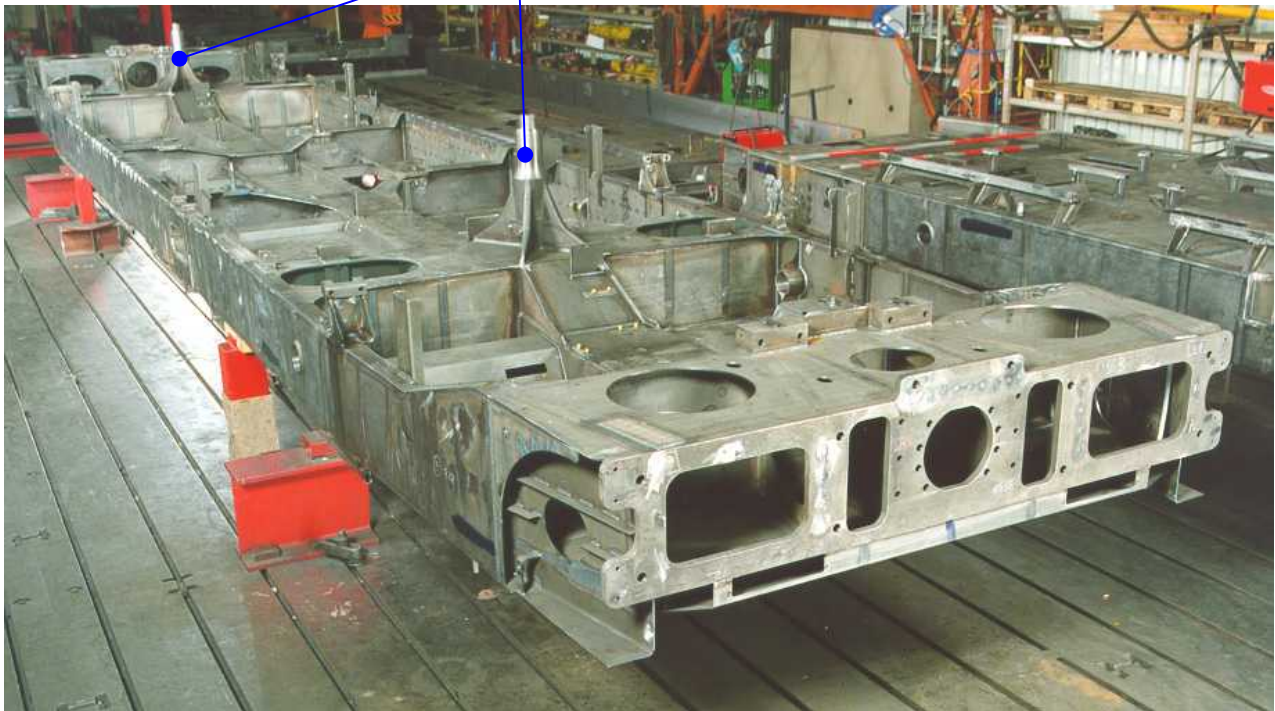
Abb. 4-2: Főkeret (felfordított állapotban) forgócsapok láthatók
