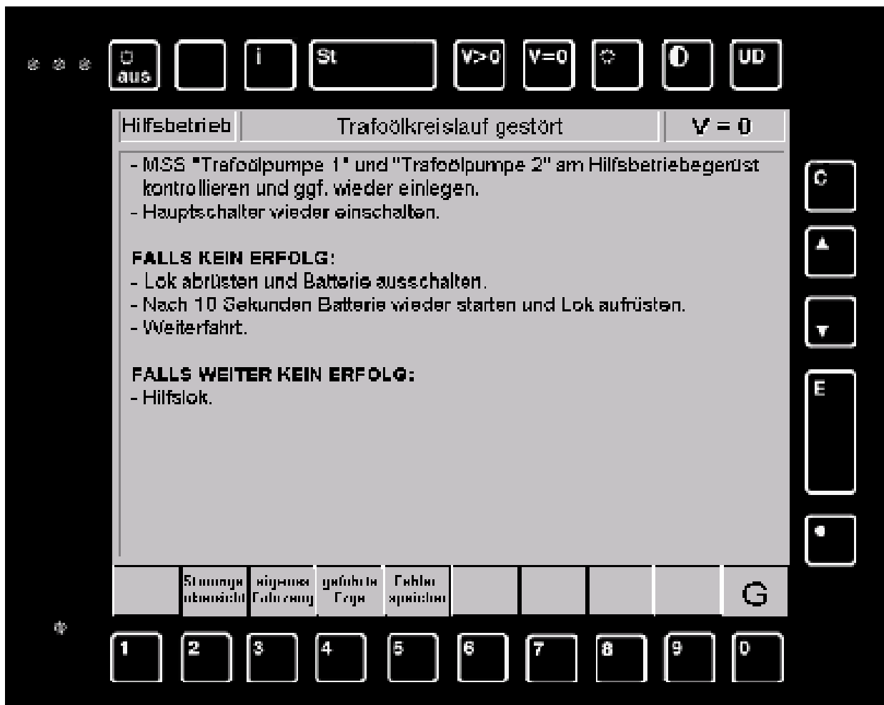
Abb. 18-32: Hibaelhárítást segítő szöveg „v = 0“-nál
