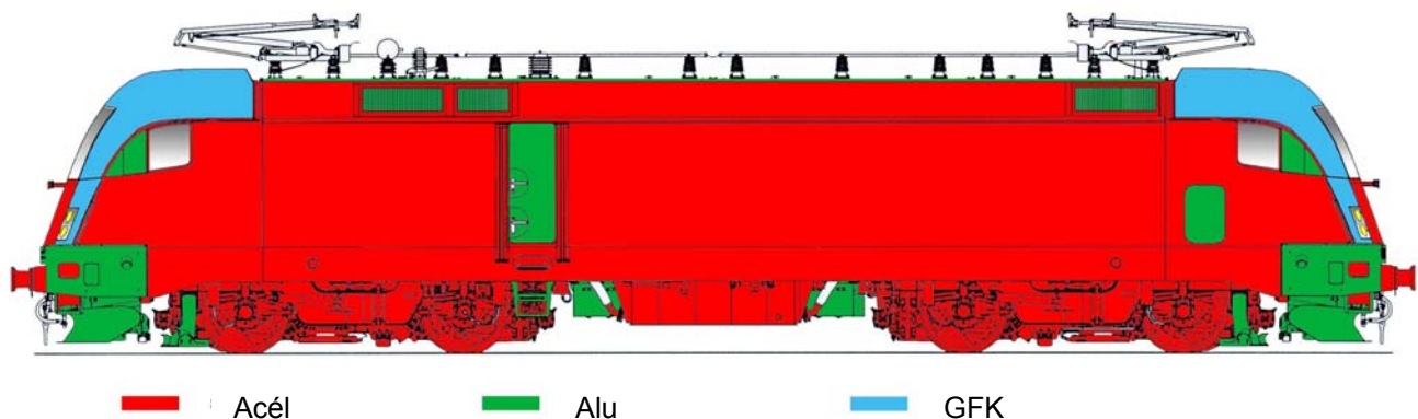
Abb. 4-1: Járműszekrény (a különböző építőanyagok színnel megkülönböztetve)
