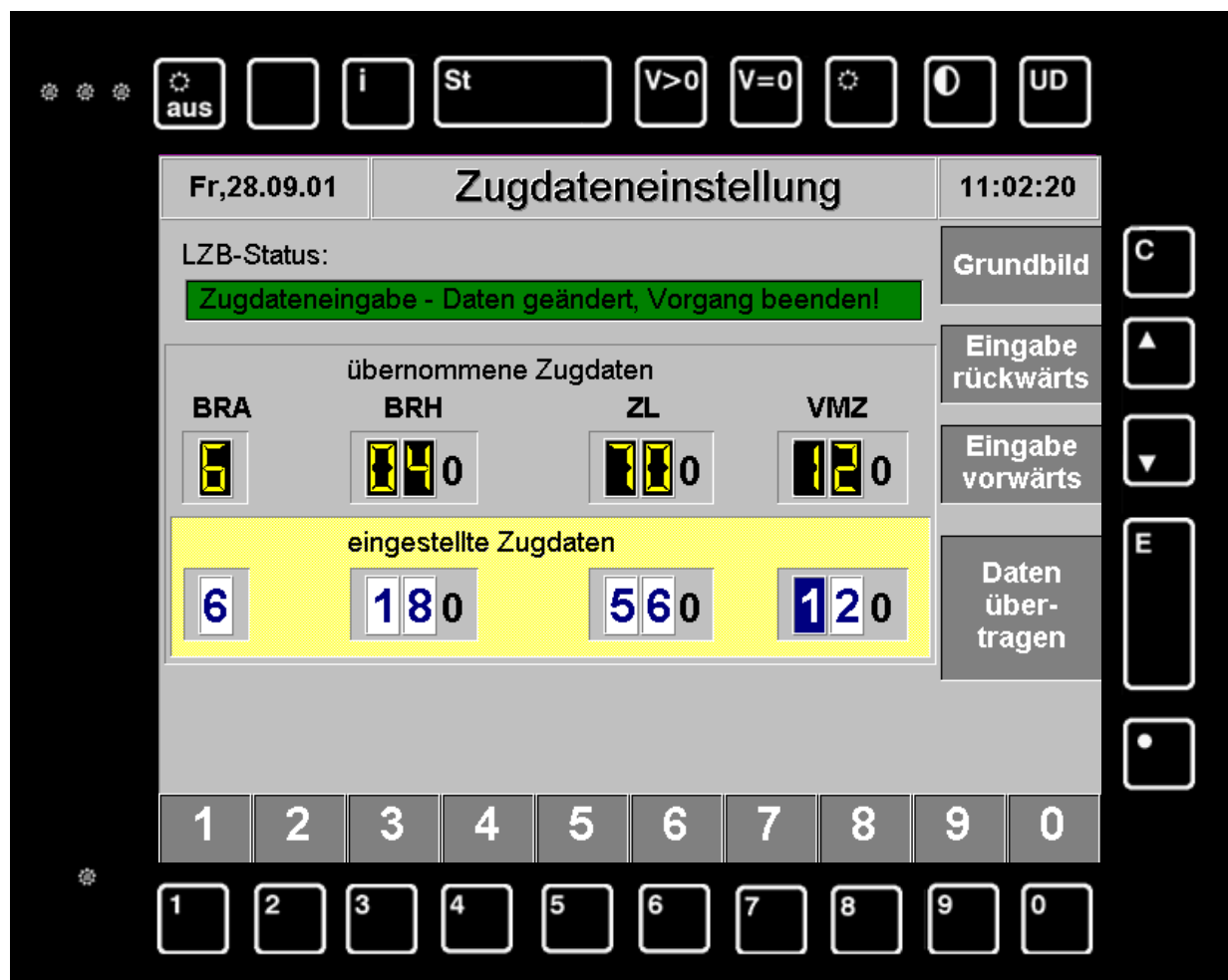
Abb. 18-18: Megengedett legnagyobb sebesség megadása (VMZ)
