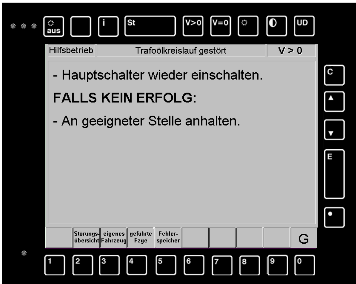
Abb. 18-31: Hibaelhárítást segítő szöveg „v > 0“-nál
