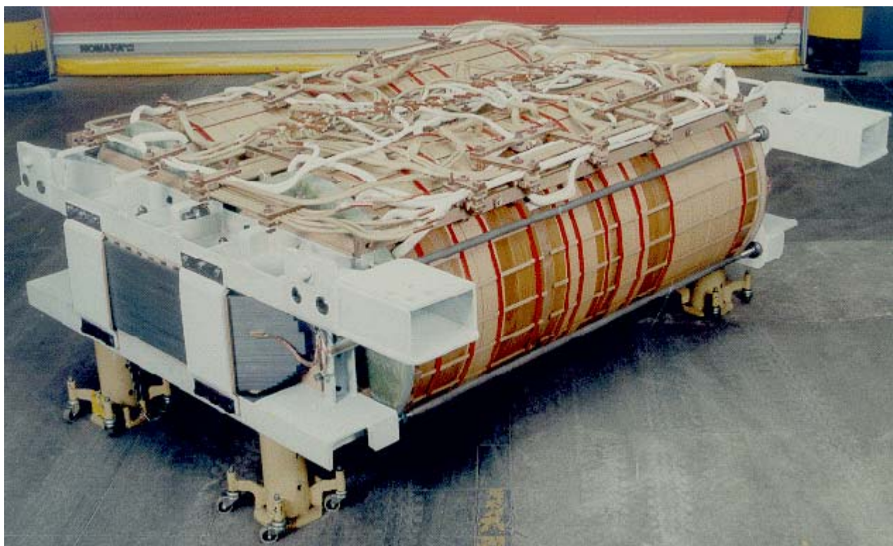
Abb. 7-2: Főtranszformátor tekercselés (kibontva)
