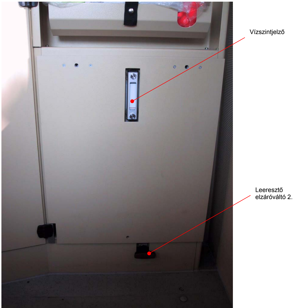
Abb.17: Alsó vízfelfogó tartály vízszintjelzővel és elzáróváltóval
