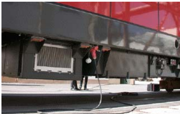
(17) ábra – Külső tápfeszültség csatlakoztatása
