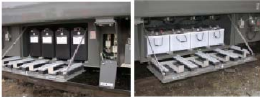
(15) ábra – Akkumulátorszekrények, biztosítékok, indító akkumulátortelep
