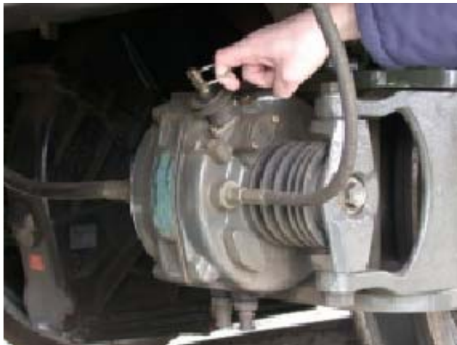
(14) ábra – Rugóerőtárolós fék szükségműködtetés
