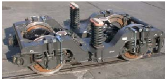
(3) ábra – Forgóváz szerkezet
