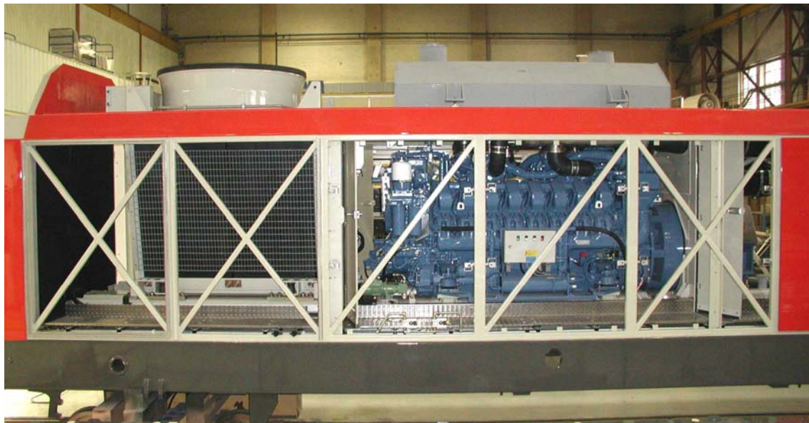
ÖBB 2016 mozdony főgépcsoport, gépészeti berendezések
