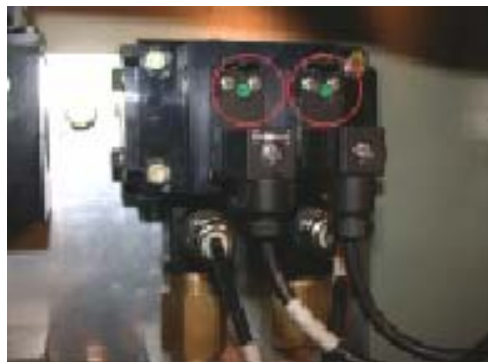
(13) ábra – Rugóerőtárolós fék impulzusszelep
