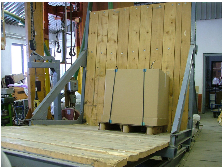
20. ábra. Ejtő vizsgálat lejtőpályás ütköztetéssel
