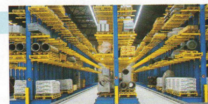
76. ábra. Rakodólapos, karos és nagyszélességű állványrendszerek
