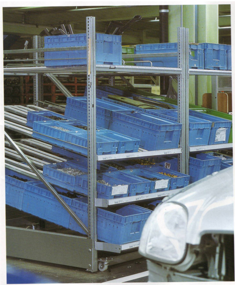
27. ábra. Különböző térfogatigényű alkatrészekből autóiipari szerelősor ellátását biztosító ládaösszetétel
