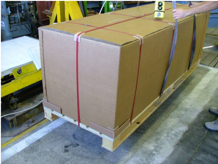
19. ábra. Ejtő vizsgálat szabadeséssel
