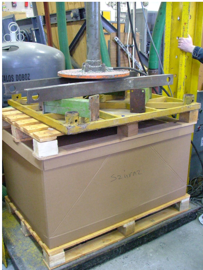
22. ábra. Halmazolhatósági vizsgálat nyomópréssel
