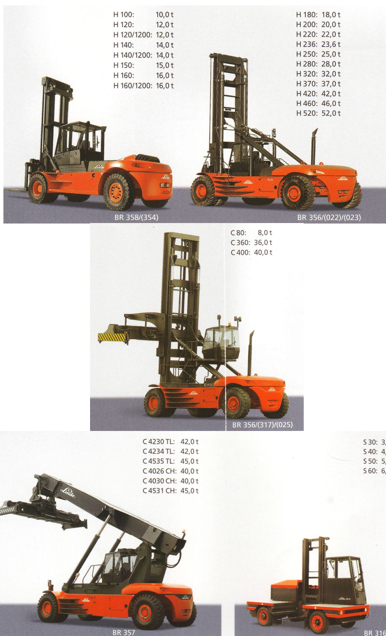
56. ábra. Különlegesen nagy teherbírású, valamint 20' és 40' ISO konténerek mozgatására alkalmas targoncák, emelővillával, illetve automata konténeremelő kerettel (spraeder)
