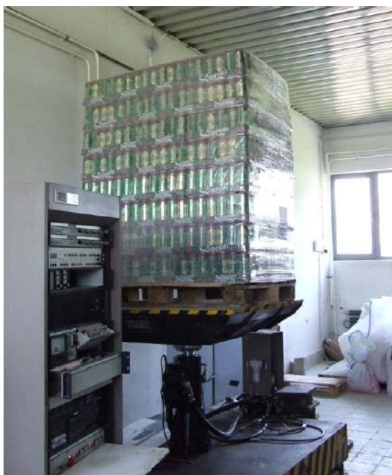
21. ábra. Rázó igénybevétel szimulálása rázó asztalon
