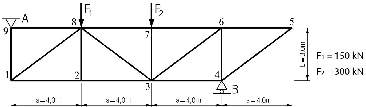
$$\sum M_A = 0 = F_1 \cdot a + F_2 \cdot 2 \cdot a + B \cdot 3 \cdot a = 150 \text{ kN} \cdot 4,0 \text{ m} + 300 \text{ kN} \cdot 8,0 \text{ m} + B \cdot 12,0 \text{ m}$$
