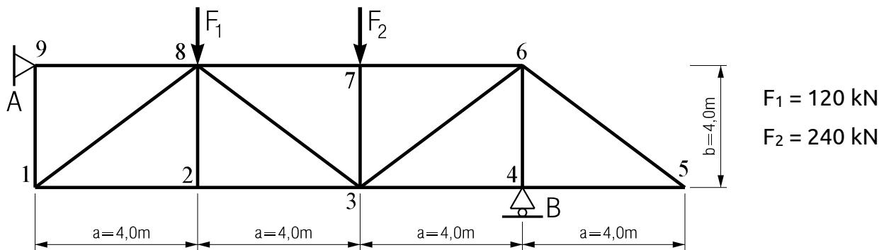
$$\begin{aligned}\Sigma M_A &= 0 = F_1 \cdot a + F_2 \cdot 2 \cdot a + B \cdot 3 \cdot a = 120 \text{ kN} \cdot 4,0 \text{ m} + 240 \text{ kN} \cdot 8,0 \text{ m} + B \cdot 12,0 \text{ m} \\ &= 480 \text{ kNm} + 1920 \text{ kNm} + B \cdot 12,0 \text{ m} = 2400 \text{ kNm} + B \cdot 12,0 \text{ m}\end{aligned}$$
