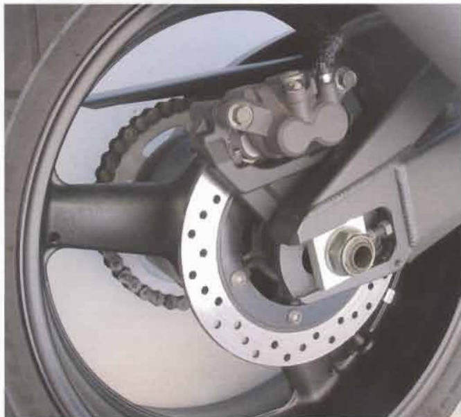
Erről szól a fékezés: elöl kettős tárcsafék, míg hátul minimáltárcsa és „törpe” féknyereg. Hatásukban is pontosan ekkora a különbség: nem több, de nem is kevesebb!
